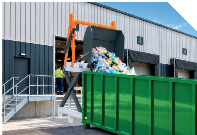
Élévation de la trémie et vidage en bord de benne
