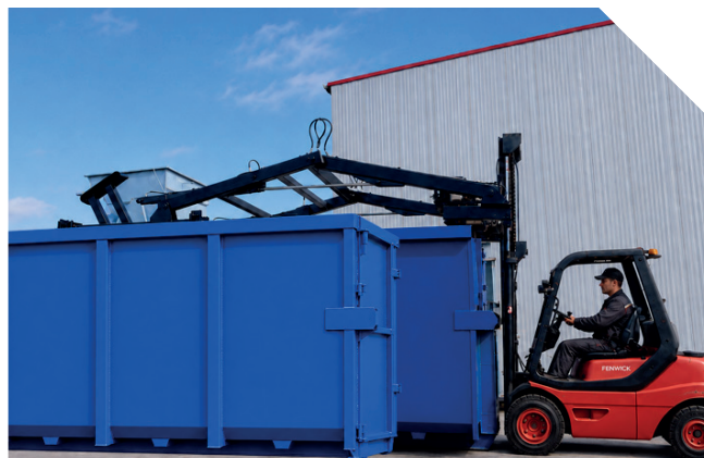
Positionnement sur la benne mobile et translation pour vidage
