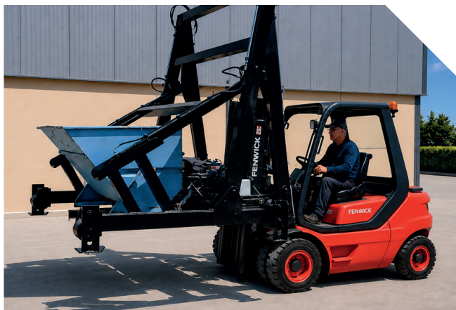
Récupération et transport des déchets dans la benne pivotante
