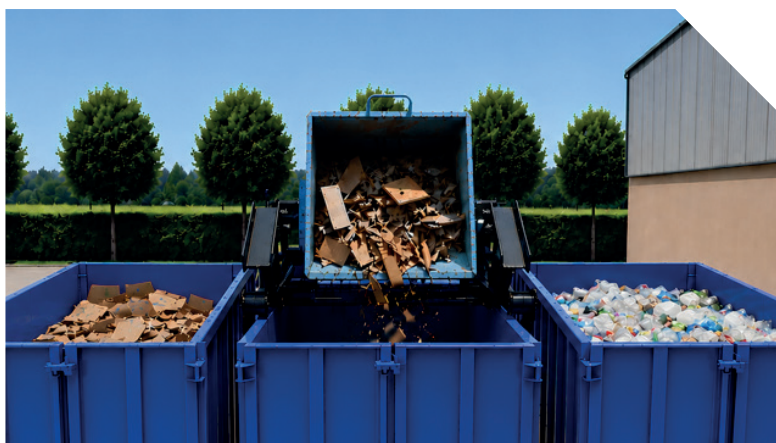
Mise en rotation de la benne pivotante et vidage dans des bennes mobiles côte à côte
