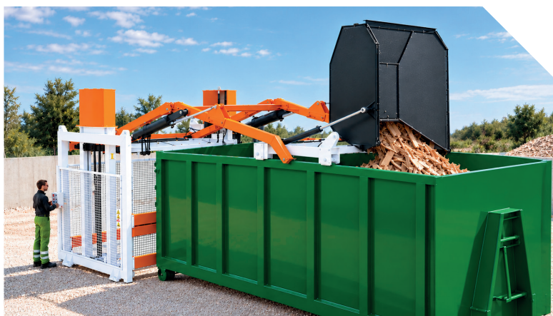
Translation de la trémie sur toute la longueur de la benne pour vider jusqu'à l'extrémité
